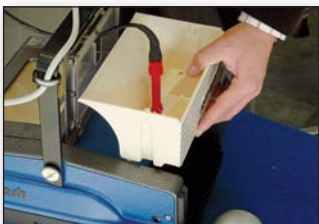
SERBATOIO ANTERIORE PER CONTENERE L'ACQUA CON IL DETERGIVO
